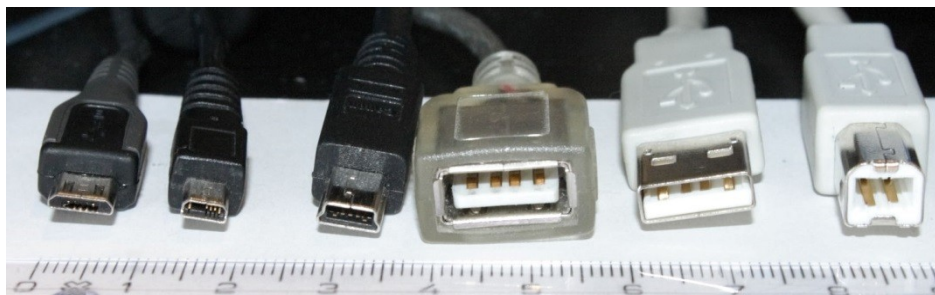
Εικ. 1.18. Διάφοροι τύποι βυσμάτων USB.
