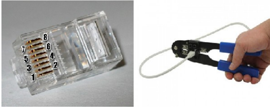
Εικ. 5.2. Βύσμα RJ45 (8P8C) και πρέσα για βύσματα RJ45.
