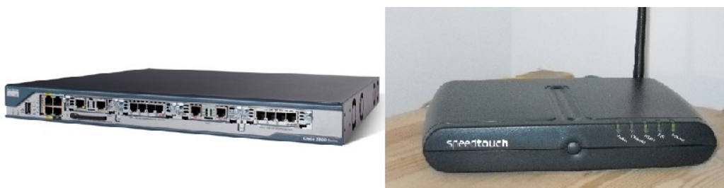
Εικ. 5.12. (α) Επαγγελματικός Δρομολογητής (β) Οικιακός Δρομολογητής aDSL
