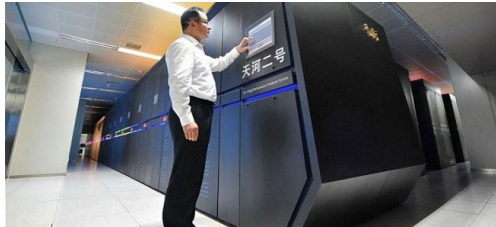
Εικ. 1.1. Ο υπερυπολογιστής «Tianhe-2», 33.86 petaflop/s (τετράκις εκατομμύρια υπολογισμοί ανά δευτερόλεπτο)
