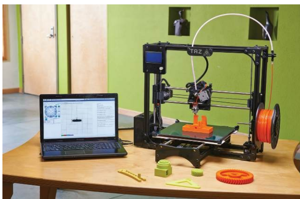
Εικ.1.33. Οικιακός 3D εκτυπωτής που η λειτουργία του στηρίζεται στη θερμότητα.
